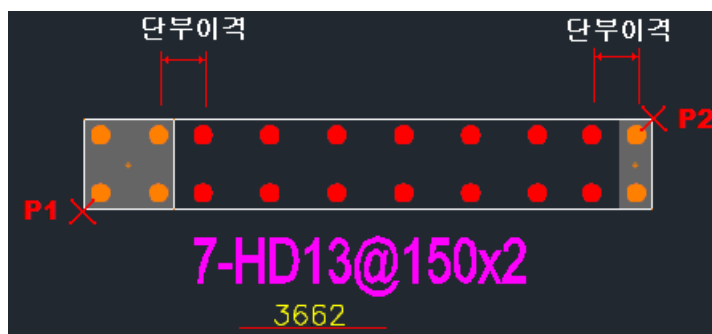
교차보강근과 단부보강근이 수직근과 연동된 상태
